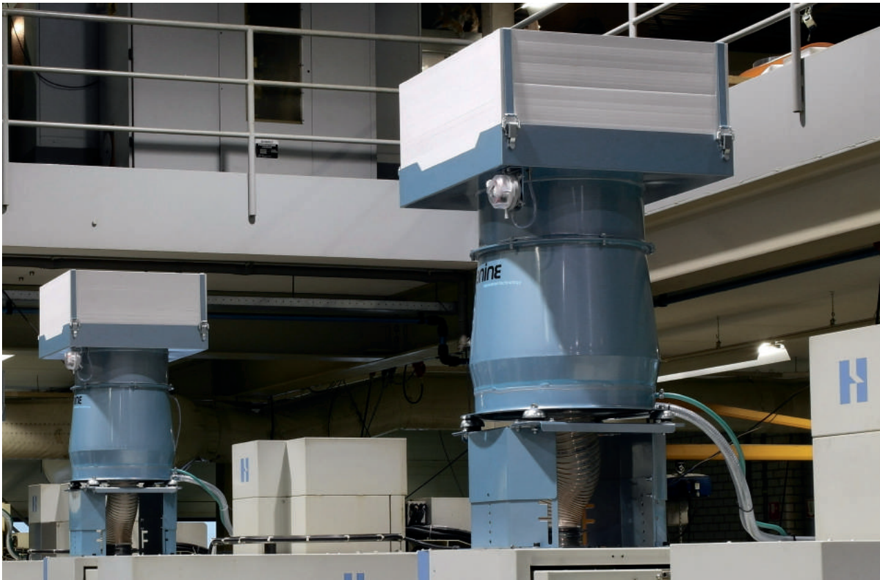
De 3Nine separatoren zijn eenvoudig op de bovenkant van de machine te monteren, waardoor ze geen extra vloeroppervlak innemen
